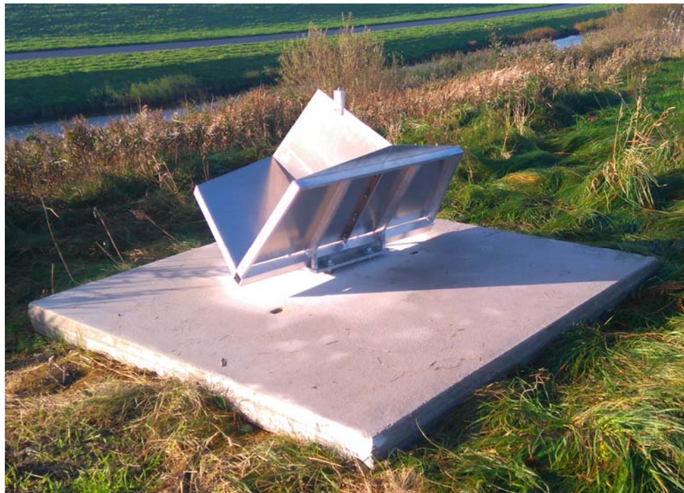
Figuur 1. Voorbeeld van een InSAR hoekreflector. De dimensies van de reflector bedragen ongeveer: lengte=120cm, breedte=80 cm, hoogte=80cm.
