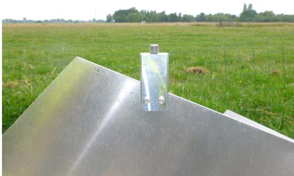
Figuur 2. Detailfoto van een hoekreflector met de adapter waarop de GNSS antenne geplaatst dient te worden.
