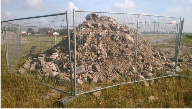
Foto 37: Dam 14 hoop grond met asbestplaatjes
