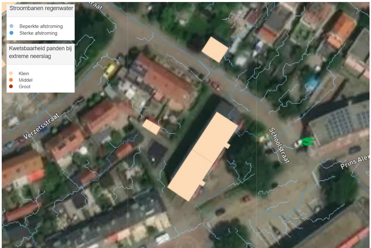
Figuur 45: Stroombanen en kwetsbare panden bij extreme neerslag op locatie 9, Dorrestein Noord (bron: Klimaatatlas Zuid-Holland)
