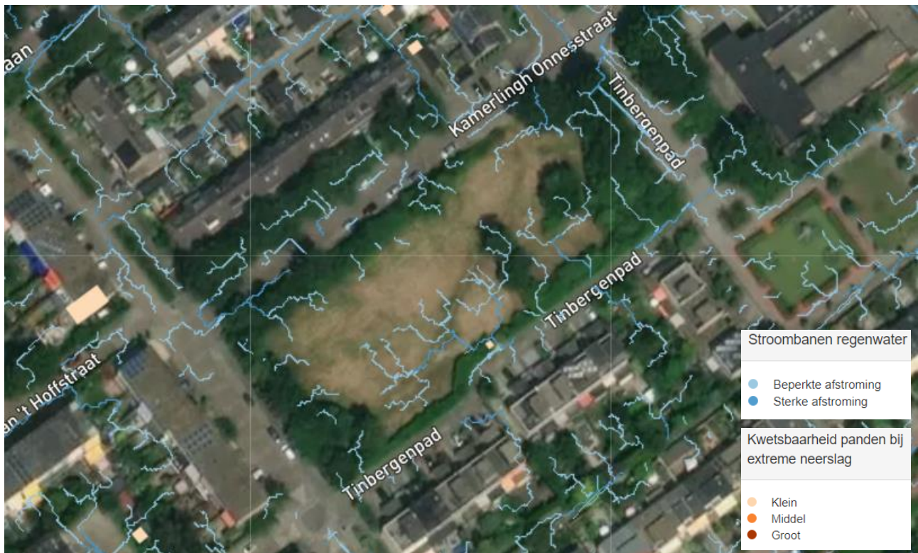
Figuur 58: Stroombanen en kwetsbare panden bij extreme neerslag op locatie 11, Dorrestein Noord (bron: Klimaatatlas Zuid-Holland)
