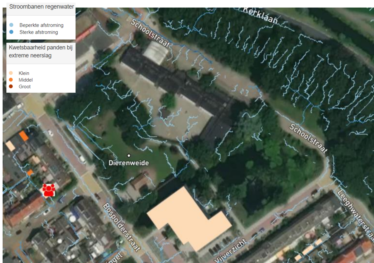
Figuur 52: Stroombanen en kwetsbare panden bij extreme neerslag op locatie 11, Dorrestein Noord (bron: Klimaatatlas Zuid-Holland)
