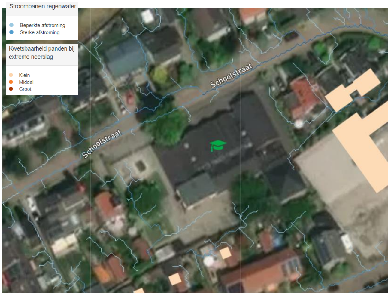
Figuur 49: Stroombanen en kwetsbare panden bij extreme neerslag op locatie 11, Dorrestein Noord (bron: Klimaatatlas Zuid-Holland)
