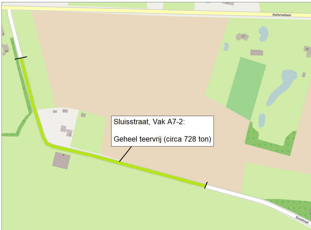
Afbeelding 3-3 Resultaten asfaltonderzoek Vak A7 (bron: Cyclomedia StreetSmart)
