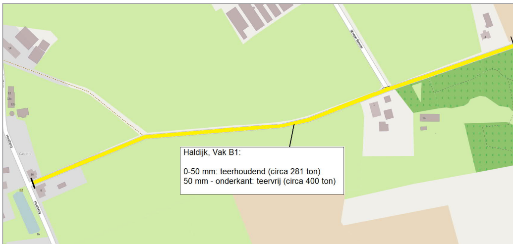
Afbeelding 3-1 Resultaten asfaltonderzoek Vak B1 (bron: Cyclomedia StreetSmart)
