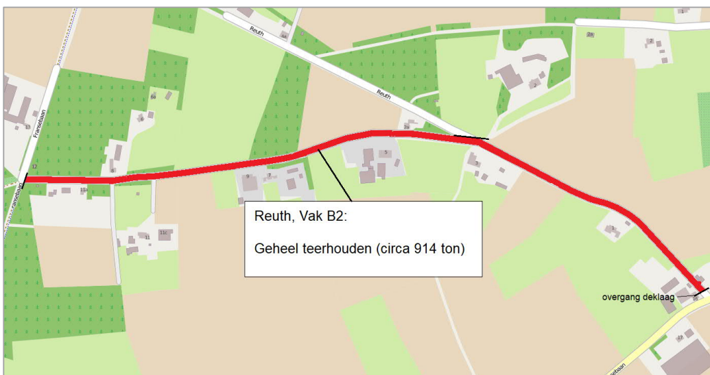
Afbeelding 3-2 Resultaten asfaltonderzoek Vak B2 (bron: Cyclomedia StreetSmart)
