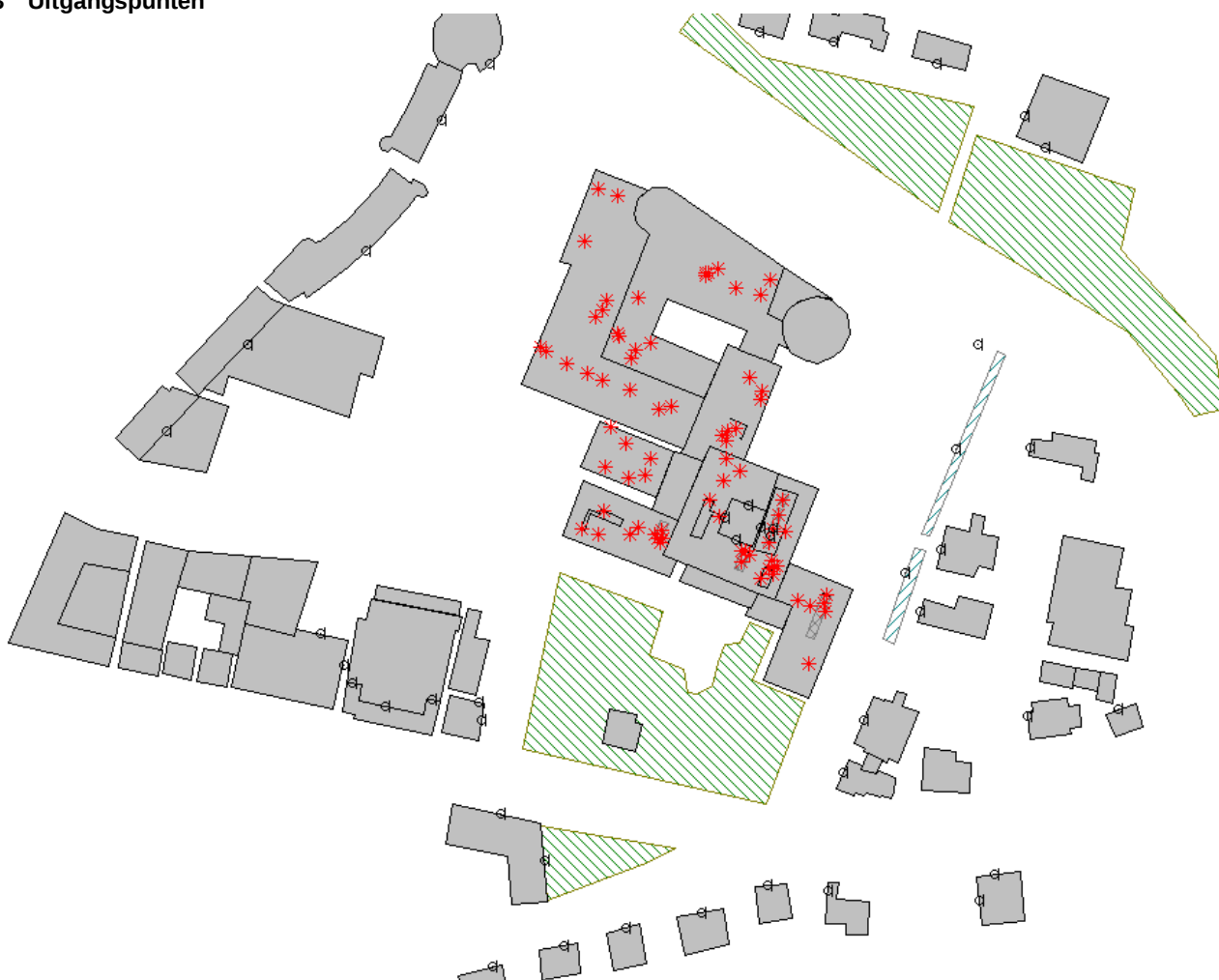
figuur 1 | Gebruikte model van het eigen gebouw (in het rood de geluidbronnen) en omliggende bouwvolumes.
