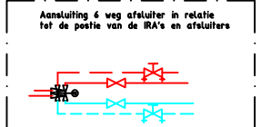
DETAIL 2: Het aansluitprincipe change-over batterijen
