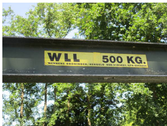
Schade: De conservering op het frame van de hijsinrichting bladdert op meerdere locaties. Oorzaak: Onvoldoende hechting van de verf op het verzinkte staal. Risico: Verminderde esthetica. Maatregel: Vervangen conservering stalen frame.
