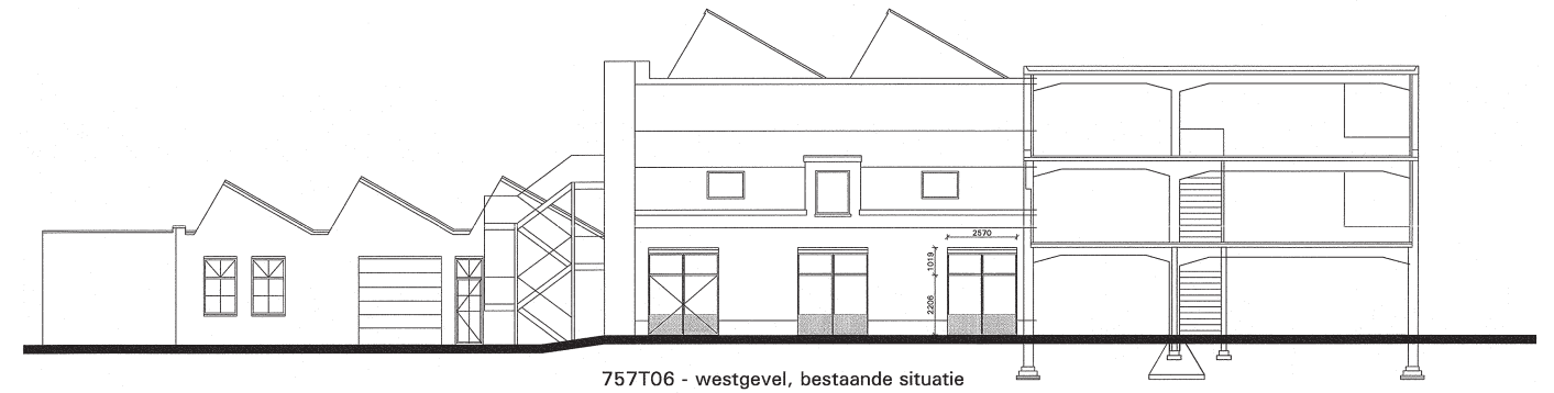
Doorsnede Drogepand: Beton skelet constructie
