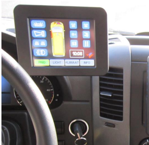
Touchscreen bedieningspaneel in chauffeurscabine direct naast het stuur.
