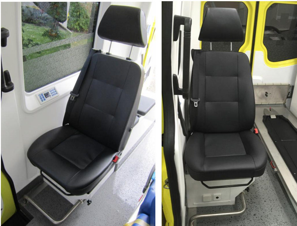
Foto verpleegkundigen stoel op afgeschuinde stoelconsole met voetensteun.
