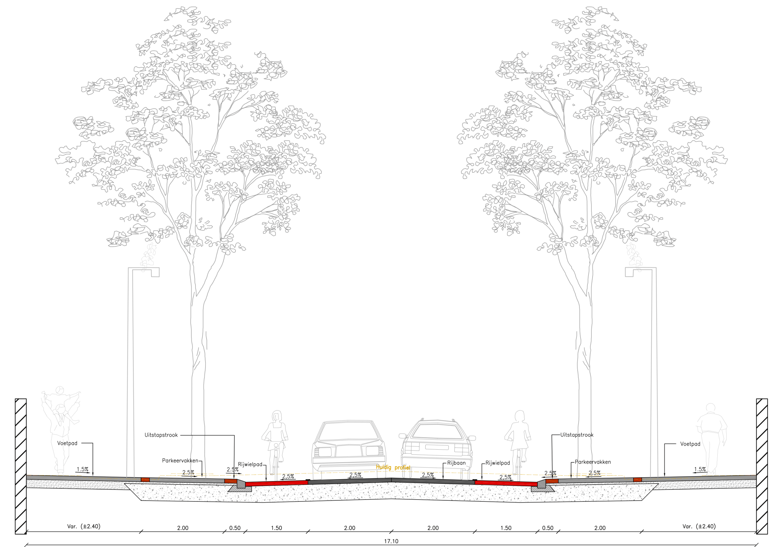
Minimaal profiel Kapellerlaan bestaande bomen Schaal 1:50
