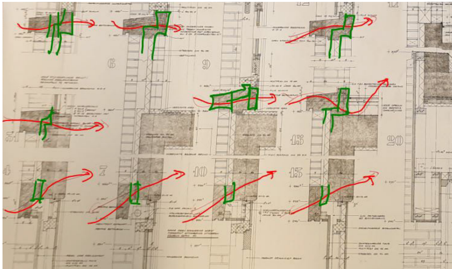
Tekening analyse constructie koudebruggen
