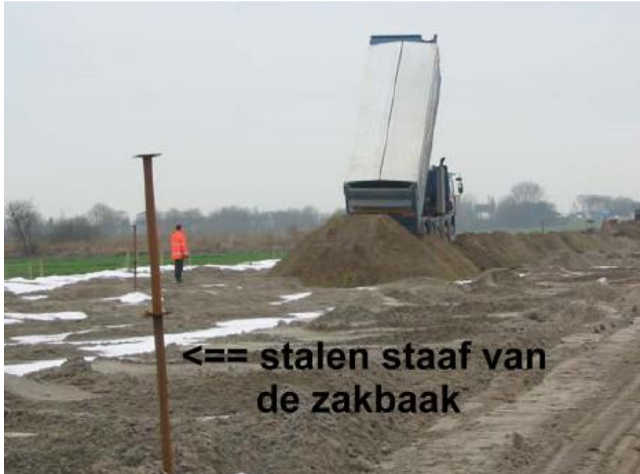
Figuur 2-1: Principe van de zakbaak.
