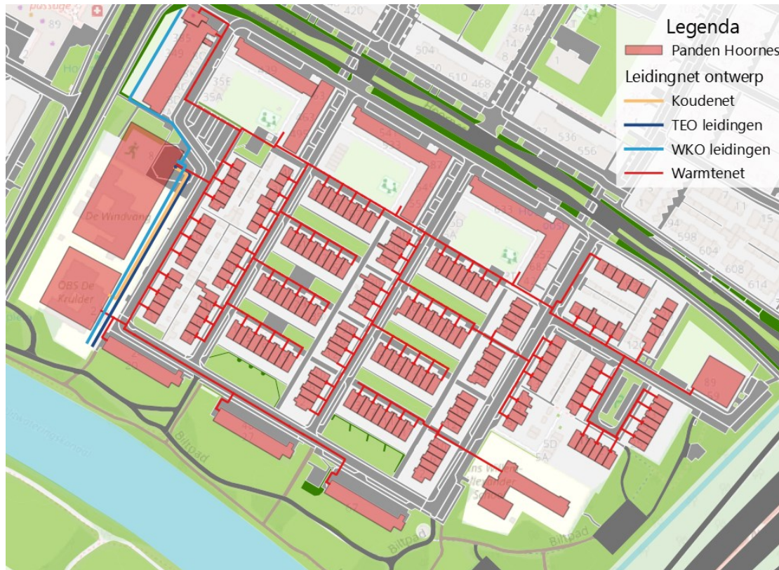
Figuur 4 - Leidingnet ontwerp van zowel warmte, koude, TEO en WKO leidingen
