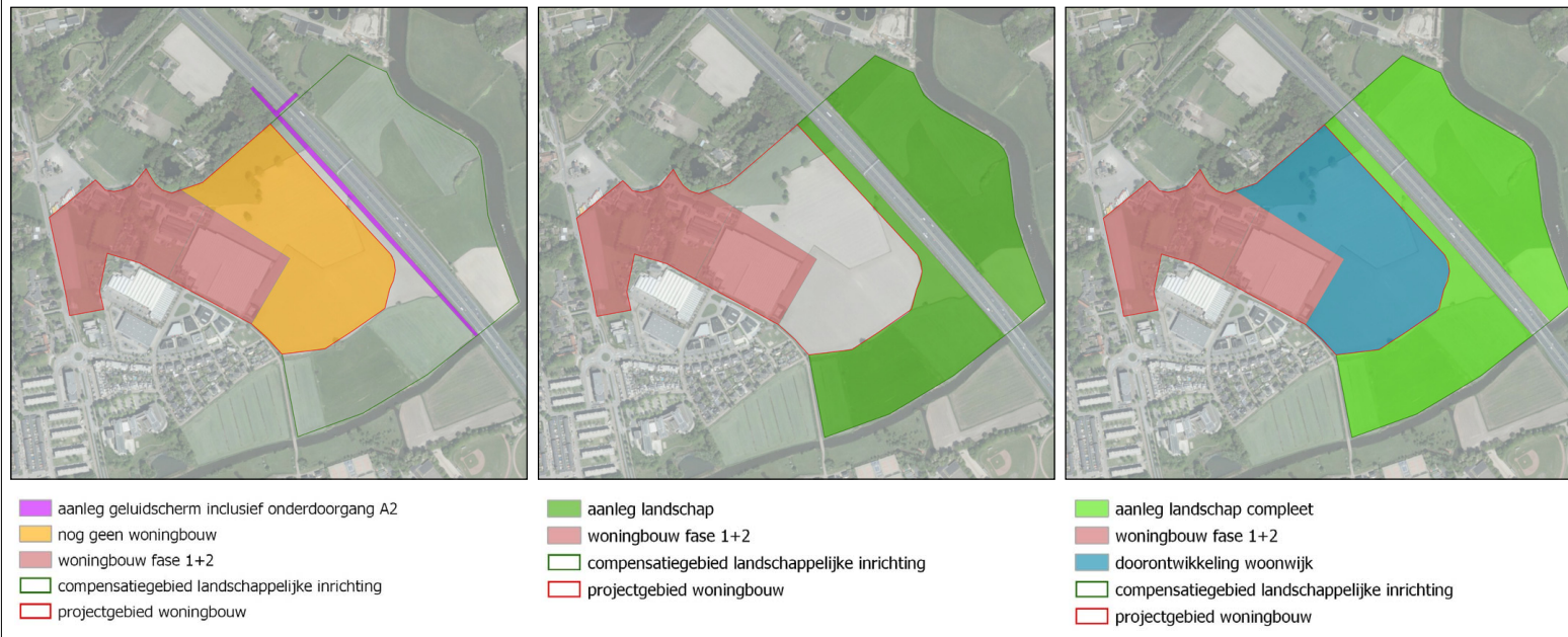
Figuur 2: stap 1 t/m 3 die de globale werkvolgorde aangeven. Bron: Landschapsplan Selissen te Boxtel, Staro 2019.
