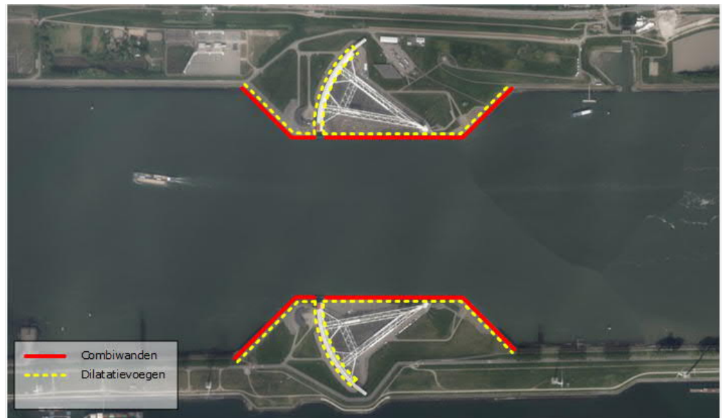
Figuur 3: Situatie combiwanden en dilatatievoegen Maeslantkering
