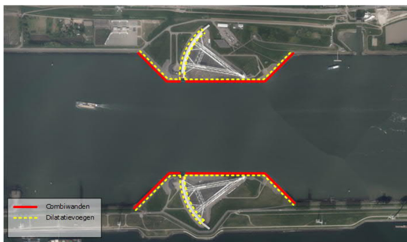
Figuur 3: Situatie combiwanden en dilatatievoegen Maeslantkering
