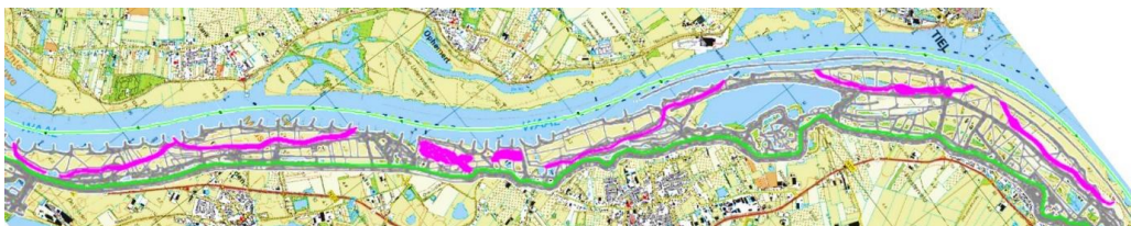
Afbeelding 1: De paarse lijnen zijn de aan te leggen geulen en overstromingsvlakten.
