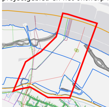
Afbeelding 8, Tracé hoogspanningsleiding en hoge druk gasleiding Wamel
