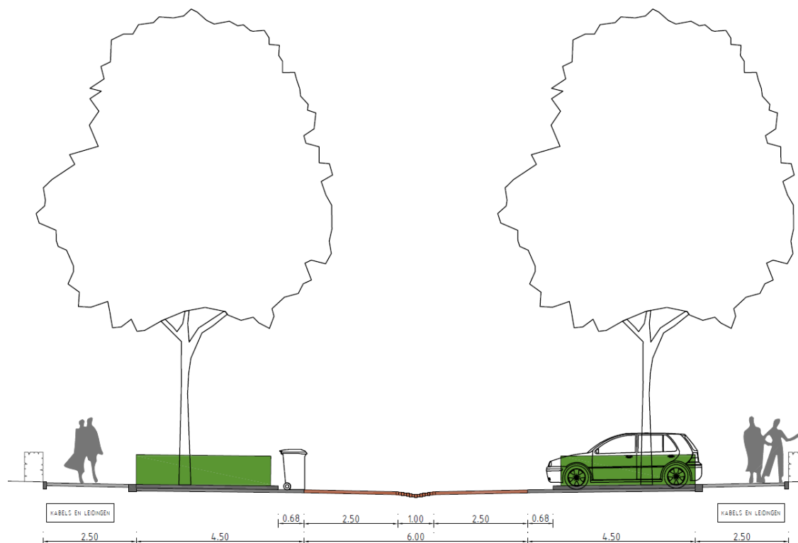
Figuur 2 Dwarsprofiel van een van de straten. Bron: Bijlage J "DO Stedenbouwkundig plan Groenpoort d.d. 06-09-2021"
