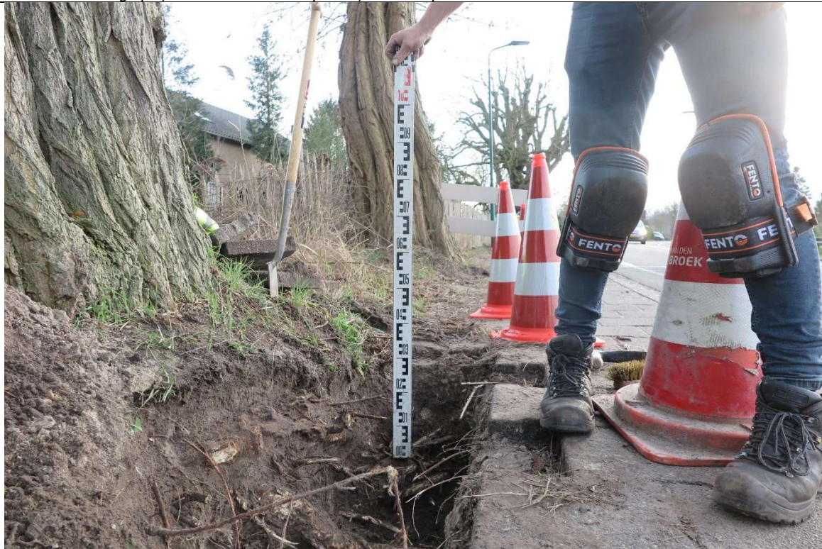
Zware beworteling op 0,2 m onder maaiveld op ca. 1,2 m uit opsluitband asfalt
