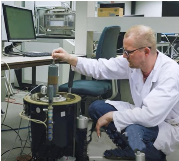
Figuur 2 Roto-erosiometer van Deltares (meting erosiebestendigheid in stroming)
