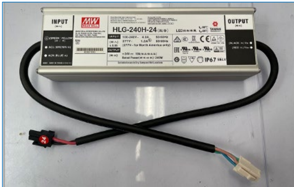
Figuur 4-7: Mean Well 12V / 240 Watt-voeding
