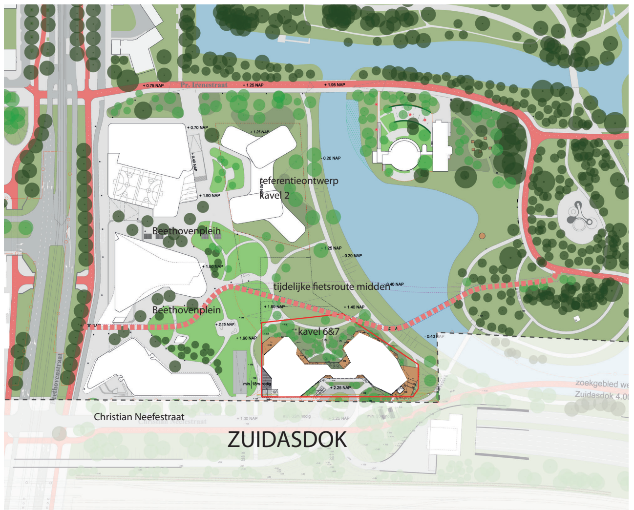
afb 8. Beethoven schetsontwerp maaiveld tweede fase met tijdelijke fietsroute in middenligging en schetsmatige verbeelding Zuidasdok (middenroute wordt vervangen door zuidelijke fietsroute)
