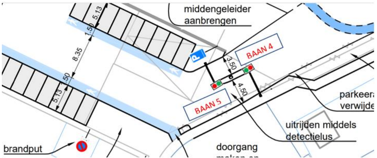
Figuur 2 Indicatie toegang bovendeck
