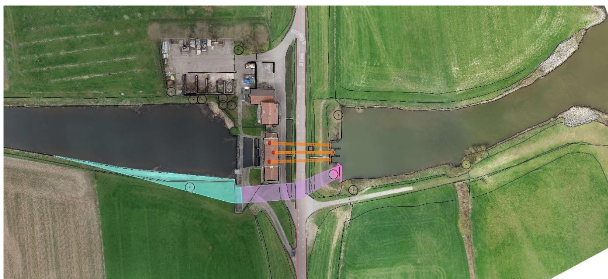
Figuur 3: Variant 2 HUIDIG: Capaciteitsuitbreiding en renovatie van pompen in bestaande gemaal en spuiwerker ten zuiden
