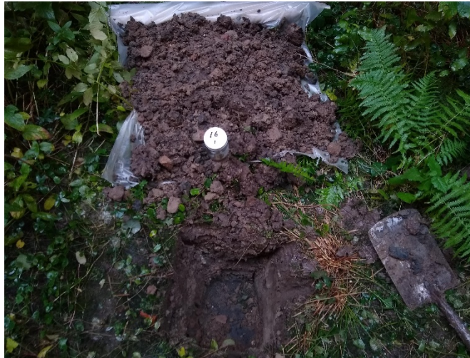
Foto 2: Asbestgat en boring (tot 2,0 m-mv) combi bij boornummer 7.
