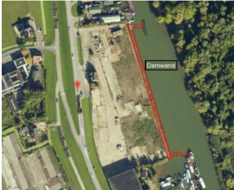
Figuur 2-8: Sectie-indeling damwand (Antea Group, 2016).
