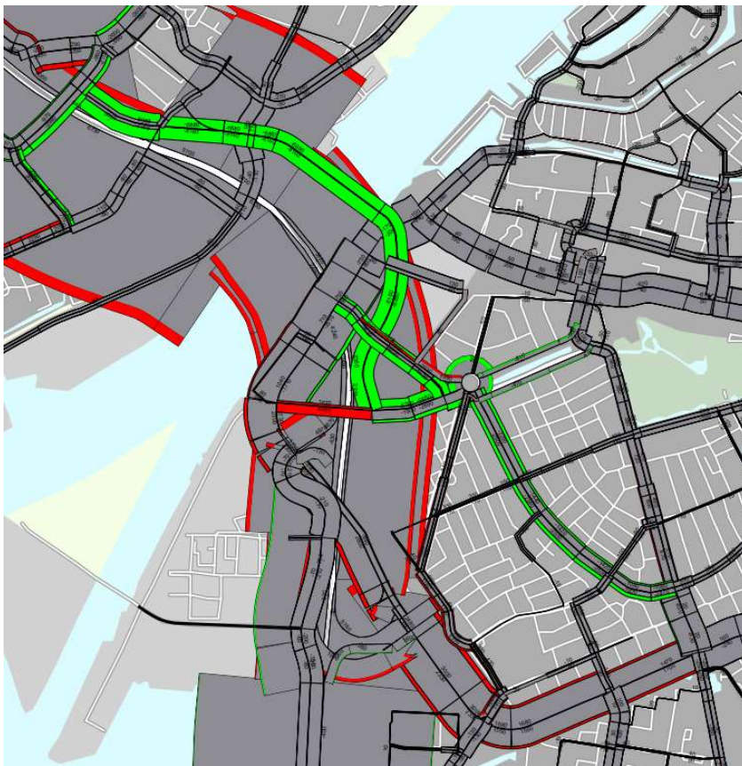
Fig. 26a. Verschuivingen van het verkeer als gevolg van de afsluiting van de Stadsbrug.
