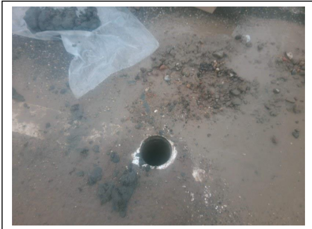
Foto 13. Opgegraven en gezeefd materiaal inspectiegat A14
