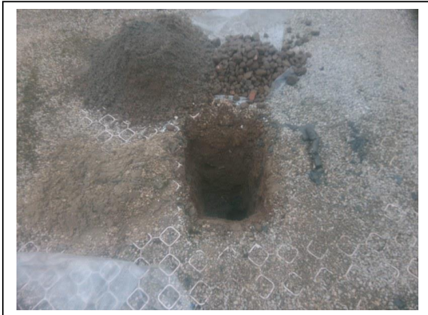
Foto 7. Opgegraven en gezeefd materiaal inspectiegat A08
