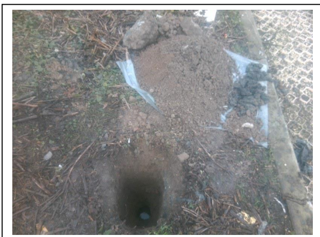
Foto 17. Opgegraven en gezeefd materiaal inspectiegat A18
