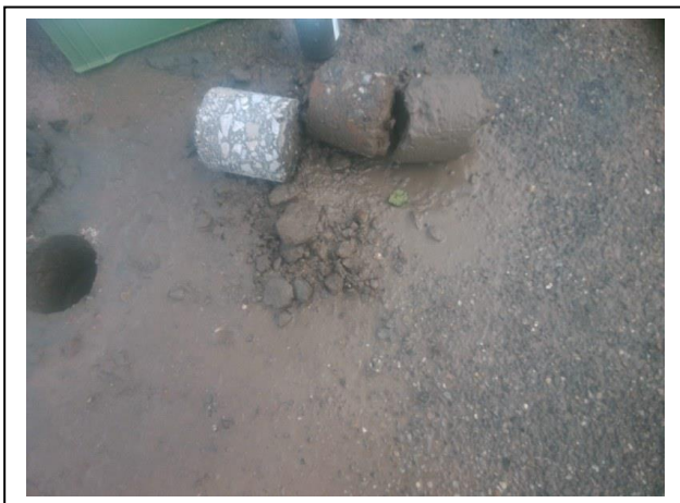
Foto 15. Opgegraven en gezeefd materiaal inspectiegat A16
