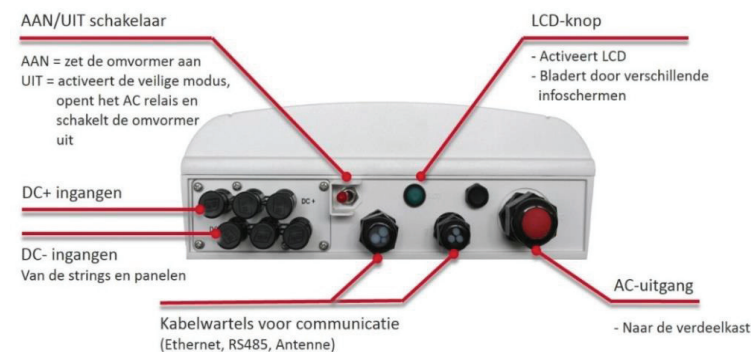
Figuur 2: De SolarEdge omvormer onderkant met schakelaar en aansluitingen
