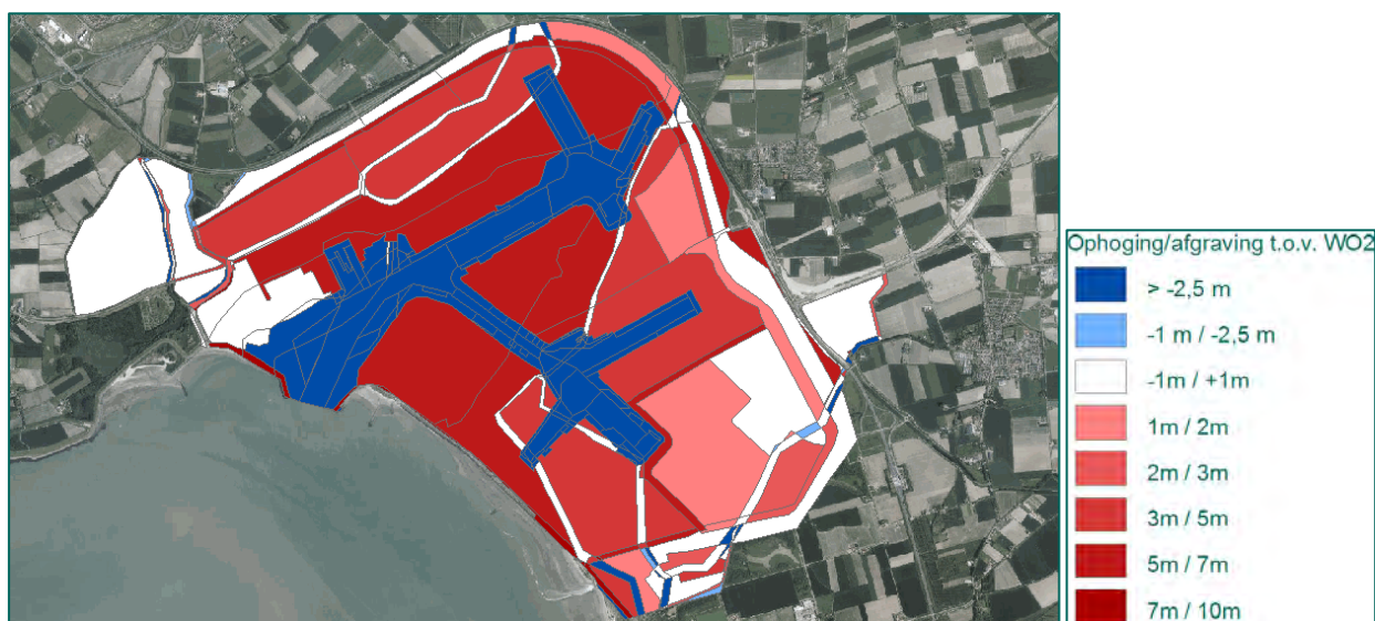
Figuur 41: Resultaat naoorlogse grondroerende werkzaamheden.
