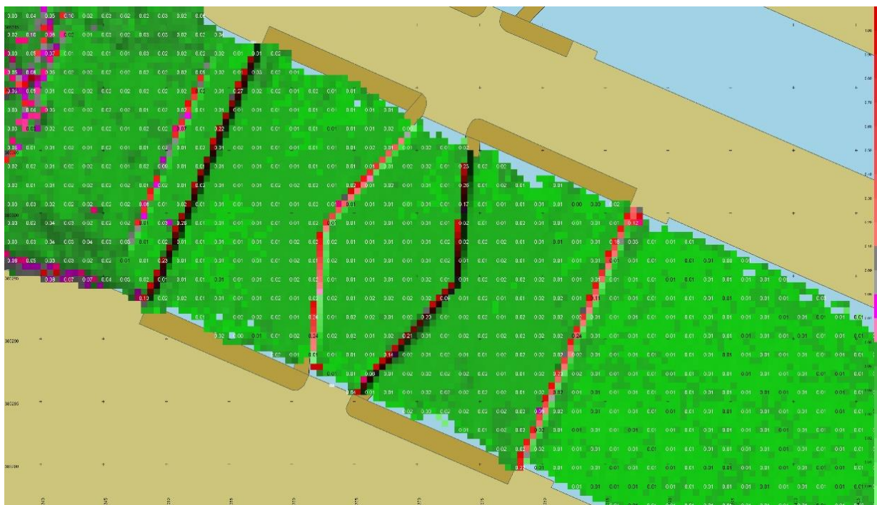
Standaard afwijkingen metingen sluisvloer in m
