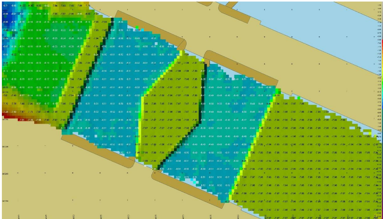
Hoogtekaart sluisvloer in m t.o.v. N.A.P
