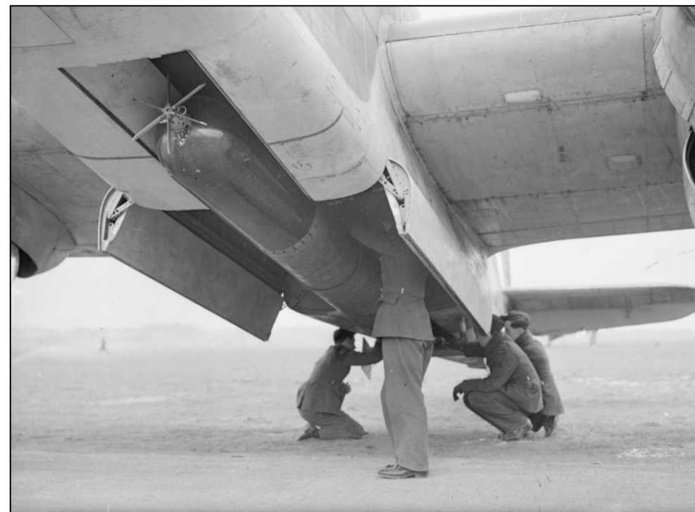
Figuur 60. In de buik van een Bristol Beaufort (No. 42 Squadron) wordt een 18 inch. Mark XII geladen. (Bron: IWM, CH2424.)
