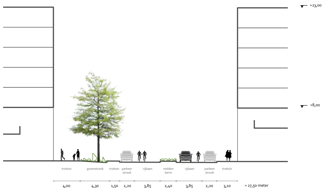
Doorsnede, nieuw profiel H.J.E. Wenkebachweg, zuidelijk deel
