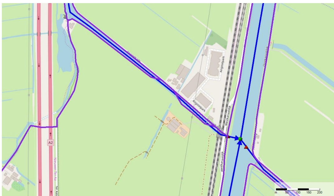
Figuur 18. Voorbeeld van een oorzaak van een lekkage van het 1D netwerk op het 2D netwerk. Met een donkerblauwe kleur zijn de oorspronkelijk 1D watergangen weergegeven en met een paarse kleur zijn de oorspronkelijke keringen voor het 2D netwerk weergegeven. Aan bovenstaande figuur blijkt dat de 2D keringen shape het 1D netwerk doorkruist waar je dit niet zou verwachten, met een lekkage tot gevolg.
