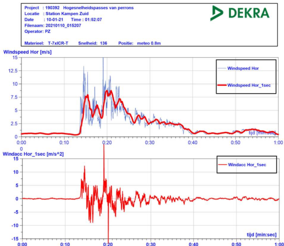
Figuur 3: Gemeten luchtsnelheden ICD (7) richting Dronten, doorsnede 2.
