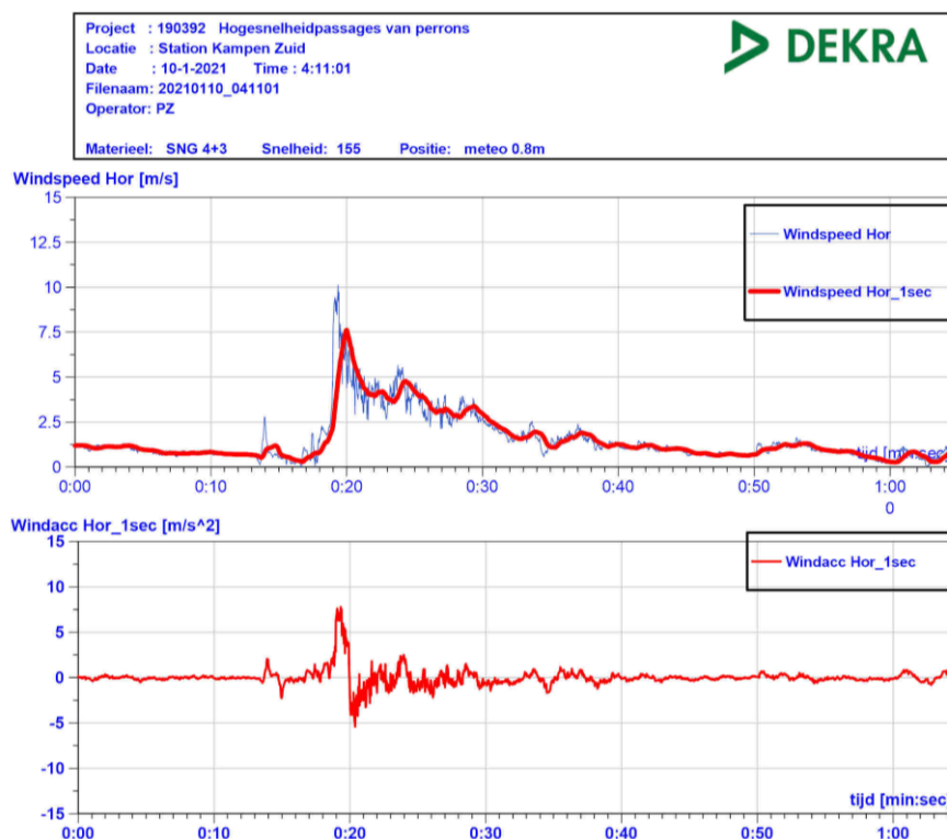
Figuur 6: Gemeten luchtsnelheden SNG(3+4) richting Zwolle, doorsnede 1.
