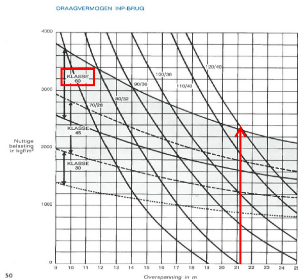
Figuur 9 Grafiek draagvermogen INP brug Spanbeton
