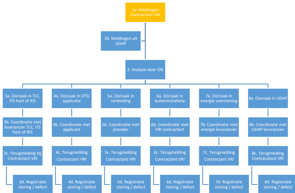
Figuur 2.3: Proces van afhandelen van meldingen, storingen en defecten op hoofdlijn.
