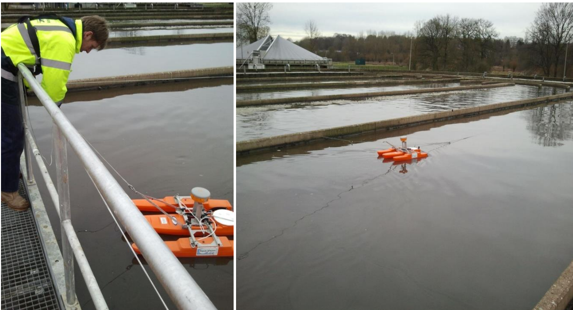
Figuur 2–2 RiverBoat uitgerust met 1200 kHz ADCP RioGrande en RTK-GPS ontvanger
