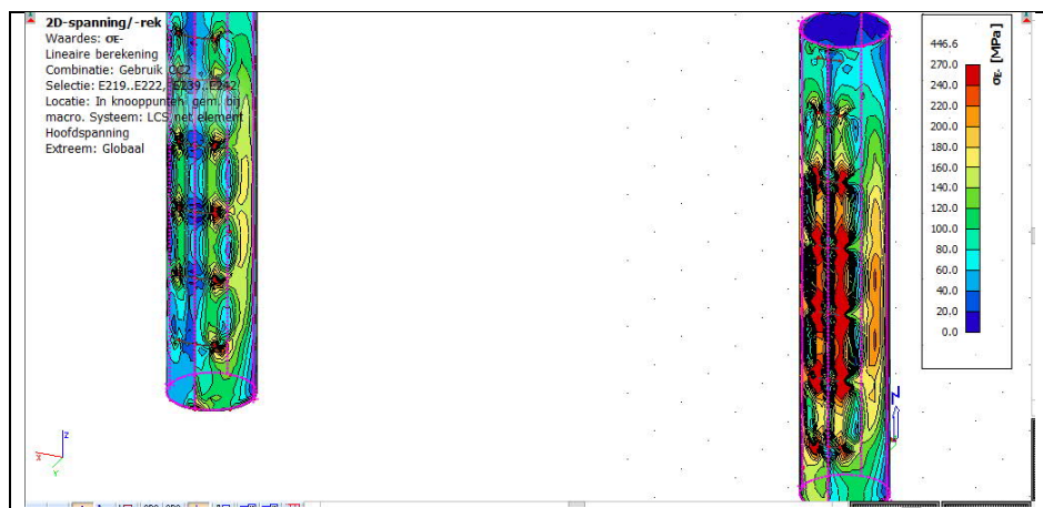
Figuur 58 Buizen nabij steunpunten – Zonder Keg – Combinatie volgens RBK – Gebruiksniveau CC2
