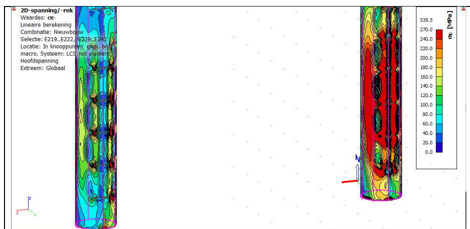
Figuur 51 Buizen nabij steunpunten – Zonder Keg – Combinatie volgens Richtlijnen RWS
