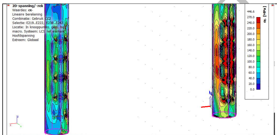
Figuur 59 Buizen nabij steunpunten – Zonder Keg – Combinatie volgens RBK – Gebruiksniveau CC2
