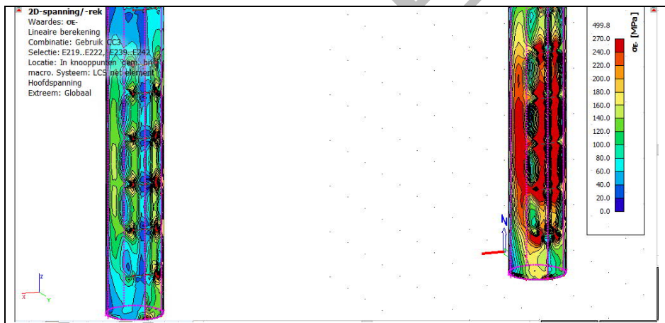
Figuur 55 Buizen nabij steunpunten – Zonder Keg – Combinatie volgens RBK – Gebruiksniveau CC3
