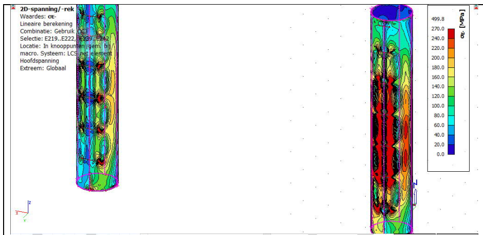
Figuur 54 Buizen nabij steunpunten – Zonder Keg – Combinatie volgens RBK – Gebruiksniveau CC3
