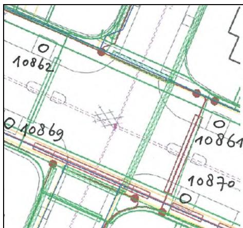
Details leidingen in Pasteurstraat: links datatransport dwars over de straat, rechts data en elektriciteit.
