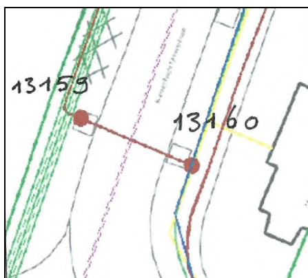
Westelijk deel Kamerlingh Onnesstraat: locatie elektriciteitskabel van boom 13159 naar boom 13160
