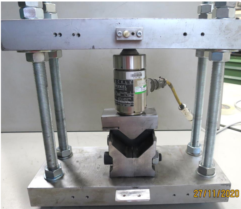
Foto 7: Testopstelling voor stressrelaxatie rubber wielblok
