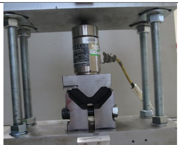
Foto 9: Inspannen van een wielblok, door het aandraaien van de boutverbindingen van de profieldelen van het binnenwiel.
