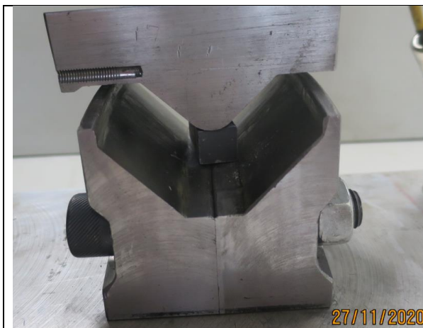
Foto 8: Blokje, gelijk aan de afstand wielband – binnenwiel, waarmee de hoogte van de platen is ingesteld.
