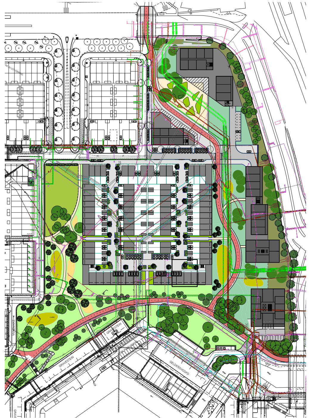
► Figuur 11.1: Kabels en leidingen
