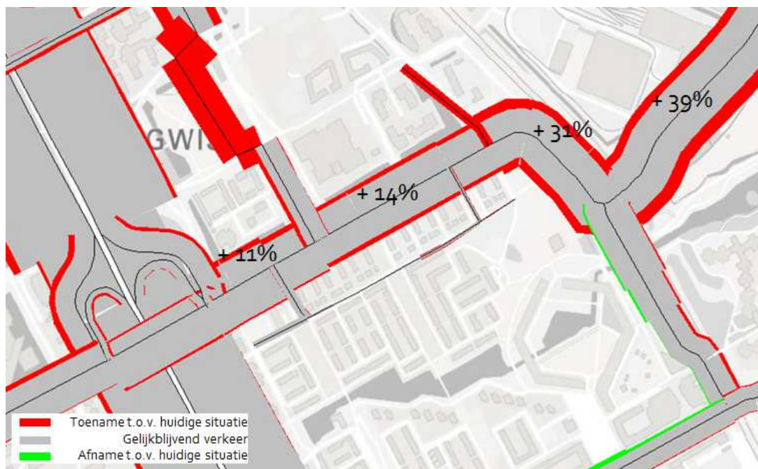
Figuur 3.7: Toe- en afname verkeer op een gemiddelde werkdag in de autonome situatie 2030 ten opzichte van de huidige situatie
