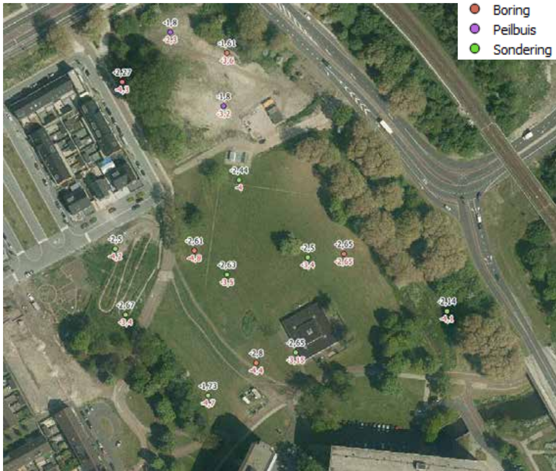
Figuur 6: Egeldonk, huidige maaiveldhoogte in m NAP (zwart) en onderkant van het freatische pakket in m NAP (rood) [3]
