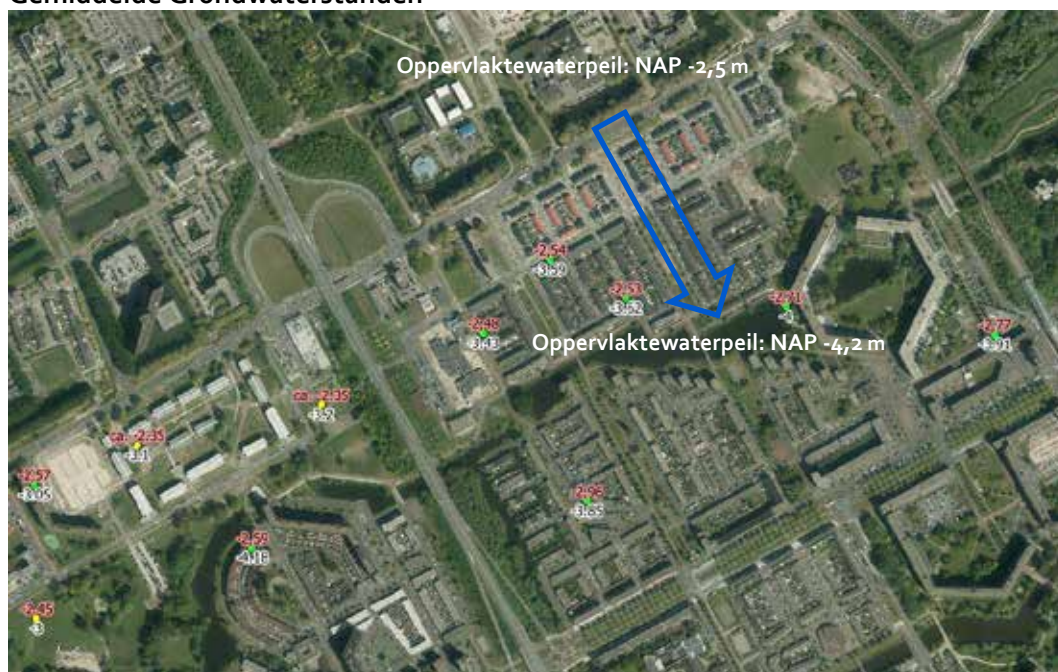
Figuur 11: Het maaiveld (roze) in m NAP en gemiddelde grondwaterstanden (wit) in m NAP in Waternet peilbuizen (groen) en Wareco peilbuizen (geel). De pijl geeft de globale freatische grondwaterstroming aan.
