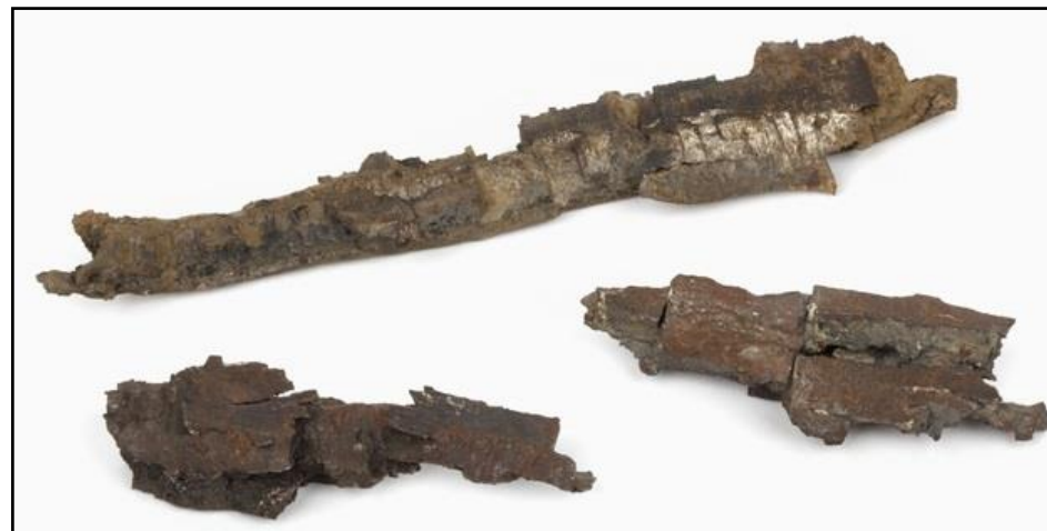
Figuur 16. Scherven afkomstig van een projectiel dat was gevuld met springstof, na detonatie.
