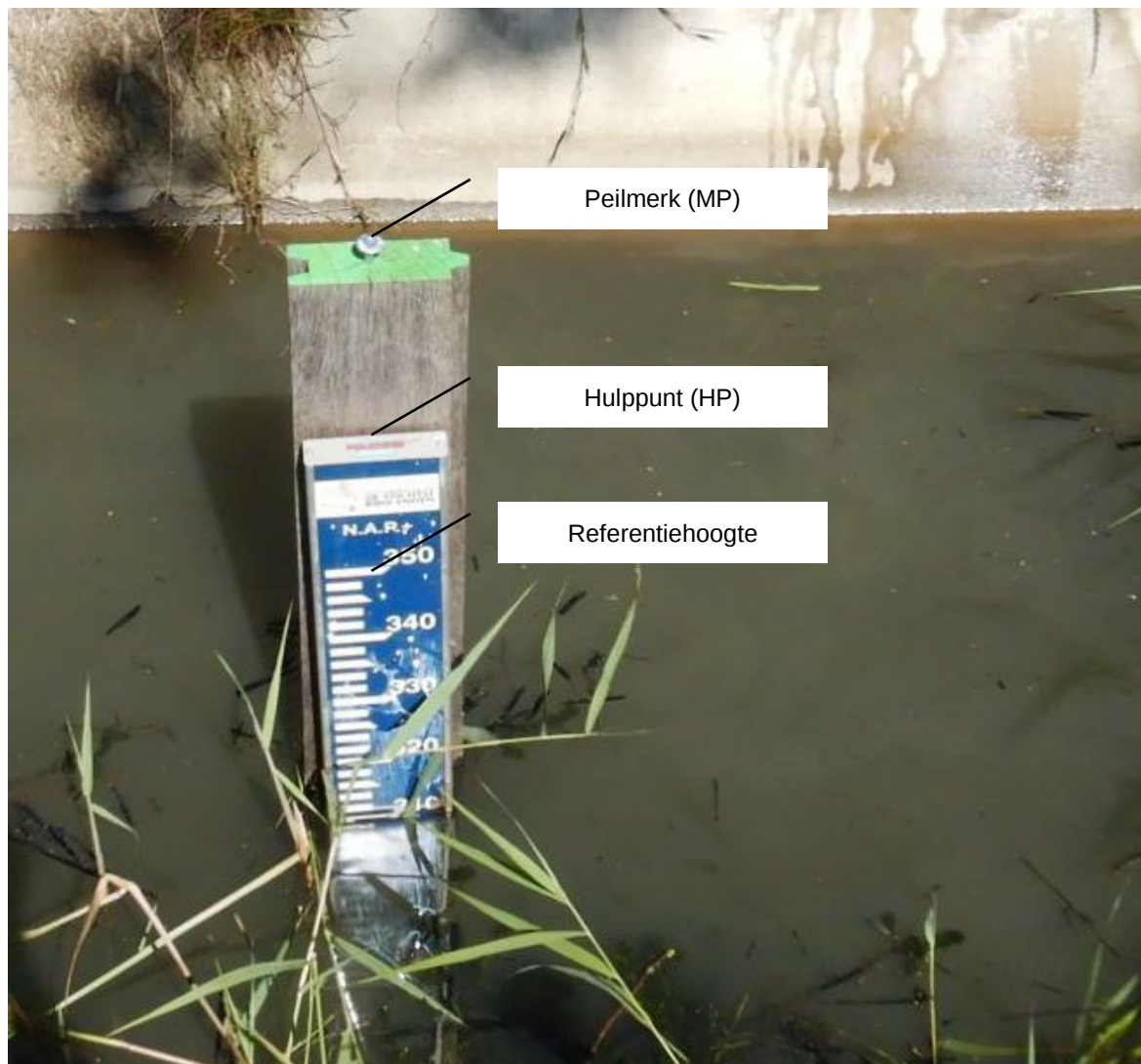
Figuur 9-1: Locatie peilmerk ten opzichte van peilschaal
