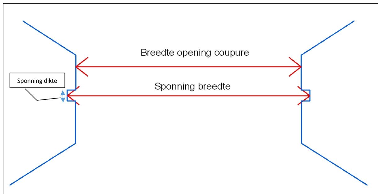
Figuur 8-16: Sponningdikte, sponningbreedte en breedte opening van coupure
