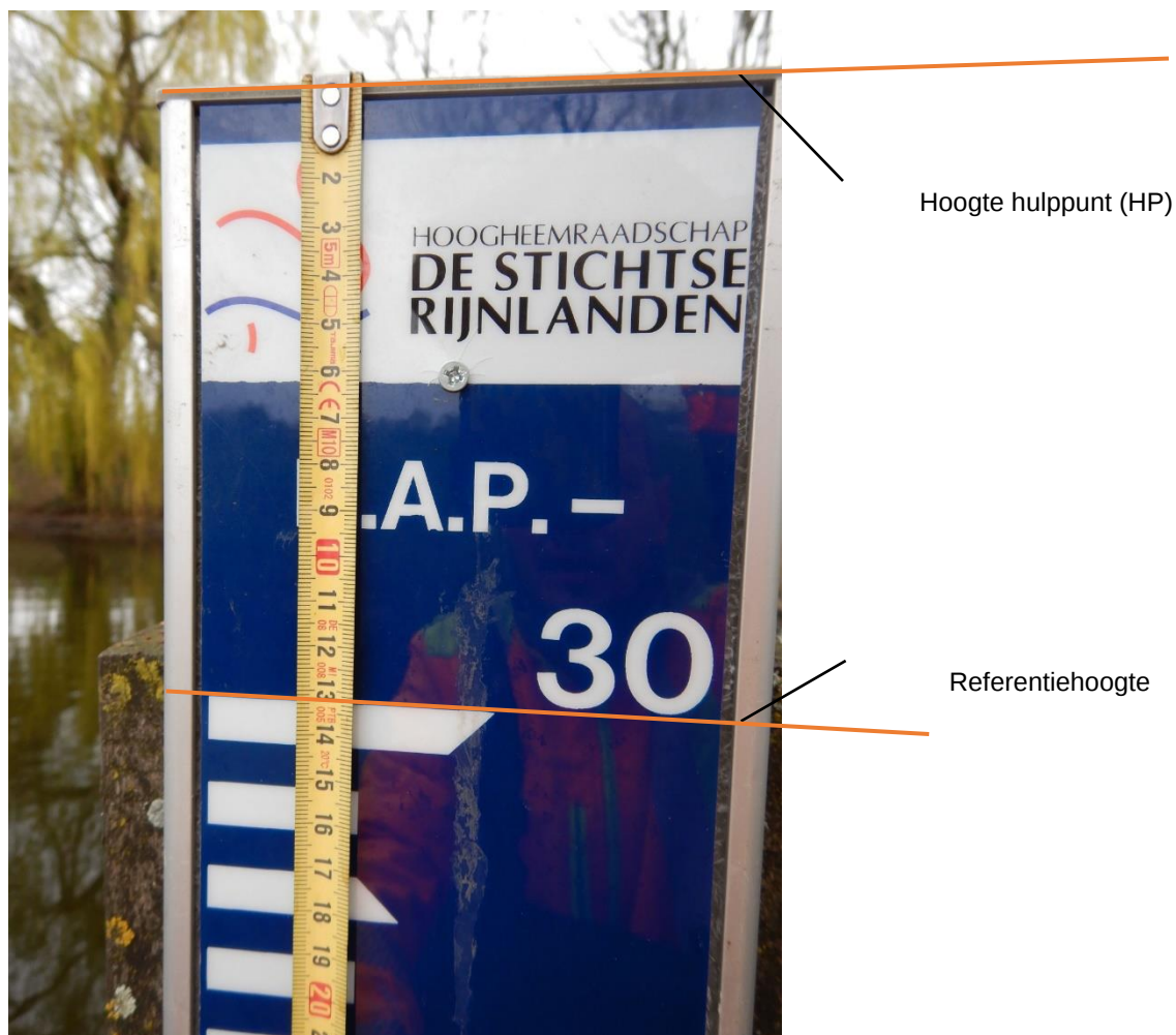
Figuur 9-2: Peilschaal met referentiehoogte en hoogte hulppunt
