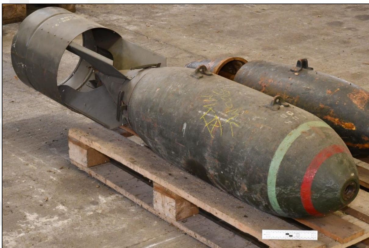
Figuur 4. Een voorbeeld van een brisantbom met een gewicht van 500 lb (Brits), in dit geval zonder ontsteker (nieuwstaat). Bron: collectie BeoBOM.
