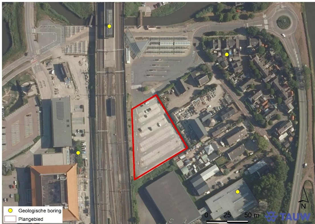
Figuur 2.1 Plangebied voor het ontwikkelen van P+R 1 garage te Breukelen arceert in rood. Gele punten geven de locatie aan van aanwezige geologische booronderzoek in de omgeving
