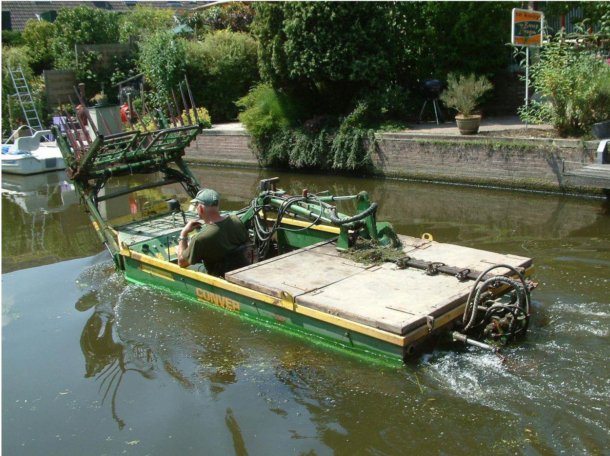
Figuur 2. Maaiboot. Foto van Wikipedia; Door S.J. de Waard - Eigen werk, CC BY 2.5, https://commons.wikimedia.org/w/index.php?curid=7178859
