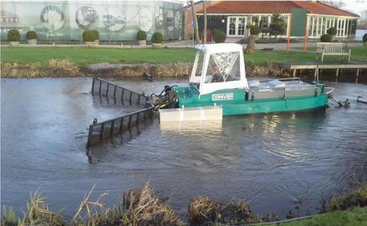
Figuur 3. Een baggerboot sleept met twee vleugels de bagger naar het punt waar deze opgescheept wordt. De boot wordt hierbij aan een kabel voortgetrokken. Foto van internet https://www.hermanoussoren.nl/materieel-item/69397573.nl
